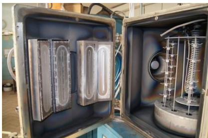
Рис. 1 – Опытный образец установки магнетронного распыления и дугового испарения
