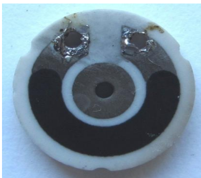
Рис. 1 – Электроискровая подгонка резистора СПЗ-44а
