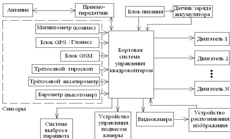
Структурная схема программно-аппаратного комплекса аварийной посадки квадрокоптера
