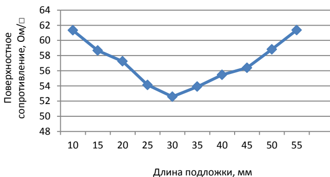
Рис. 2 – Неравномерность распределения сопротивления по поверхности подложки
